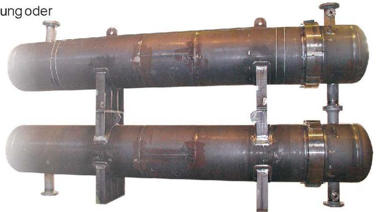
U-Rohr-Wärmetauscher in Doppel-
